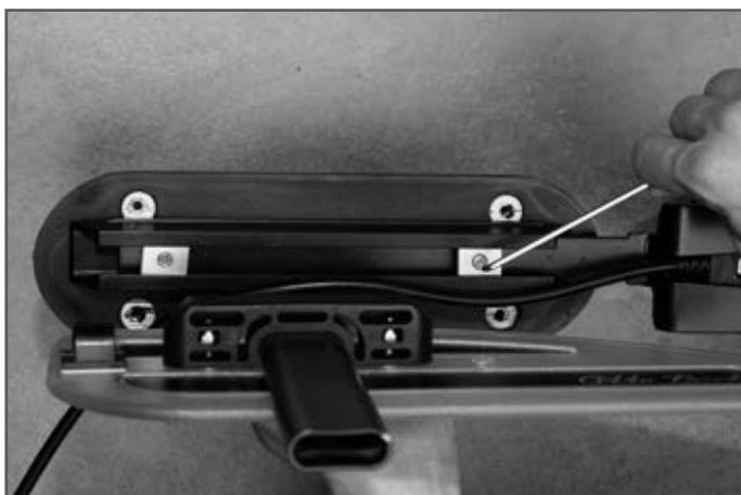
Fig. 27 Substituir o suporte do painel de comando
