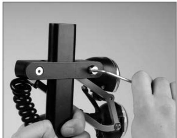
Fig. 30 Reequipar a iluminação dianteira
