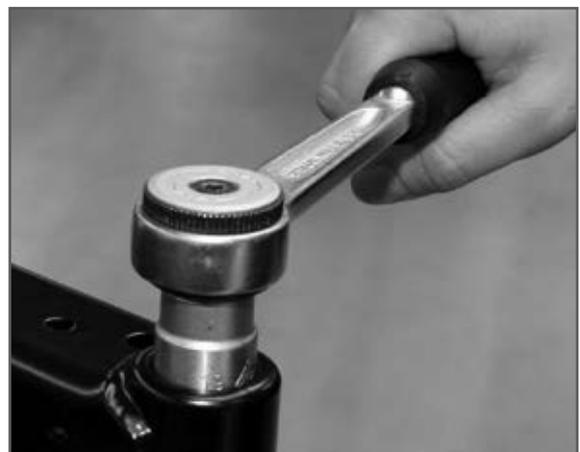
Fig. 23 Desmontar a forqueta da roda direcional
