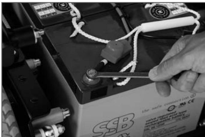
Fig. 6 Desconectar os cabos de conexão
