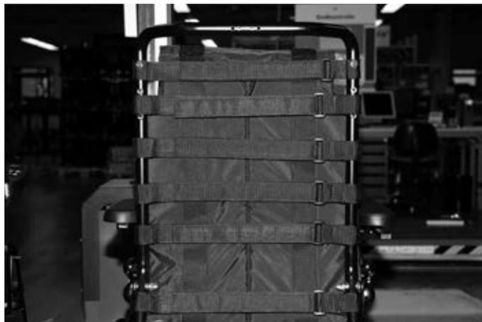
Fig. 36 Assento padrão: revestimento do encosto
