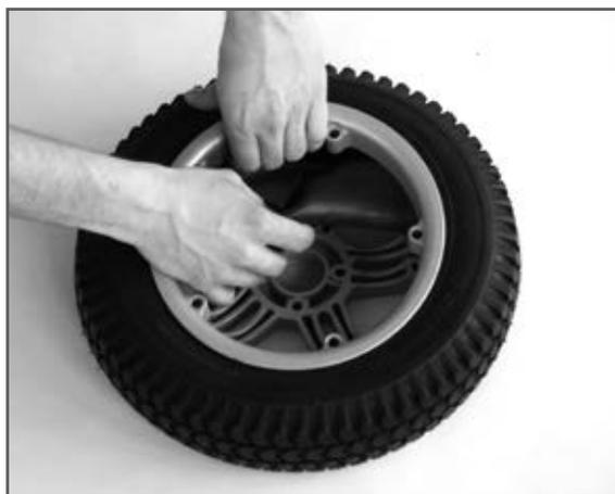
**Fig. 19** Desmontar o pneu
