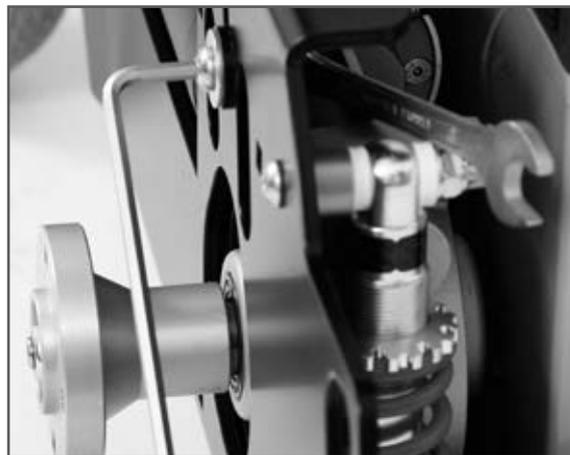
Fig. 46 Posição das arruelas deslizantes, desmontagem
