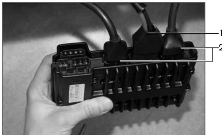
**Fig. 7** Controlador com conectores
