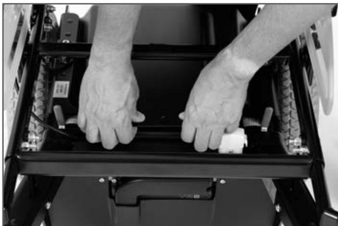
Fig. 5 Abrir a cobertura da bateria
