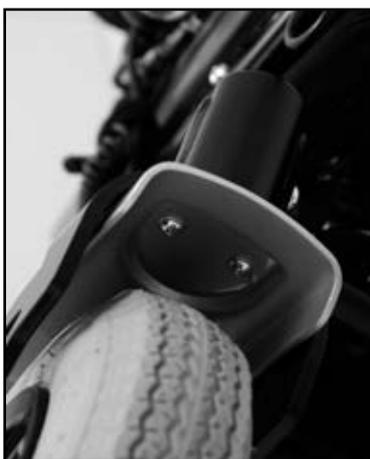
Fig. 24 Montar o para-lama para a forqueta da roda direcional
