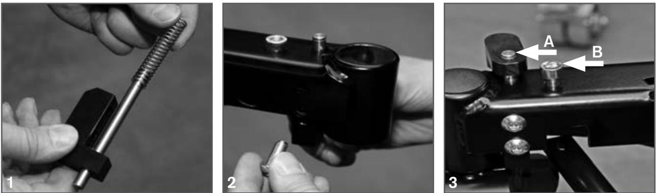
Fig. 54 Montar o bloqueio das rodas direcionais
