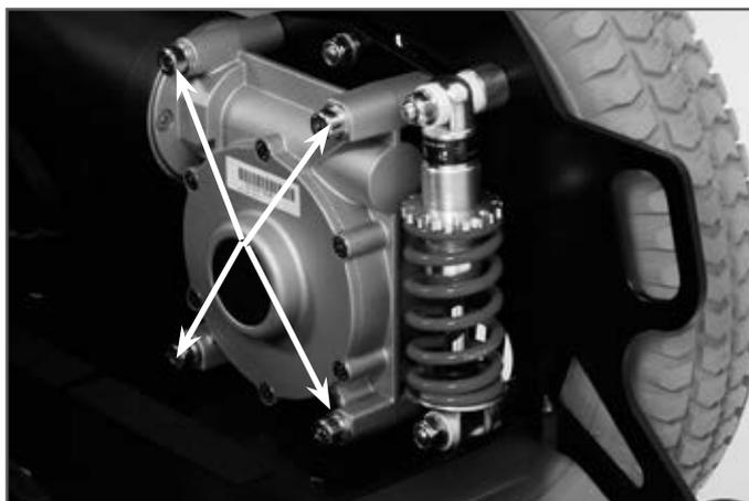
Fig. 44 Substituir o motor de acionamento
