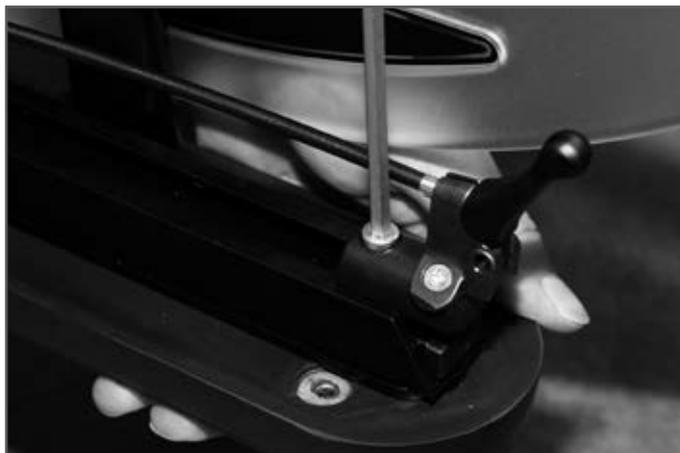
**Fig. 50** Fixar o cabo Bowden
