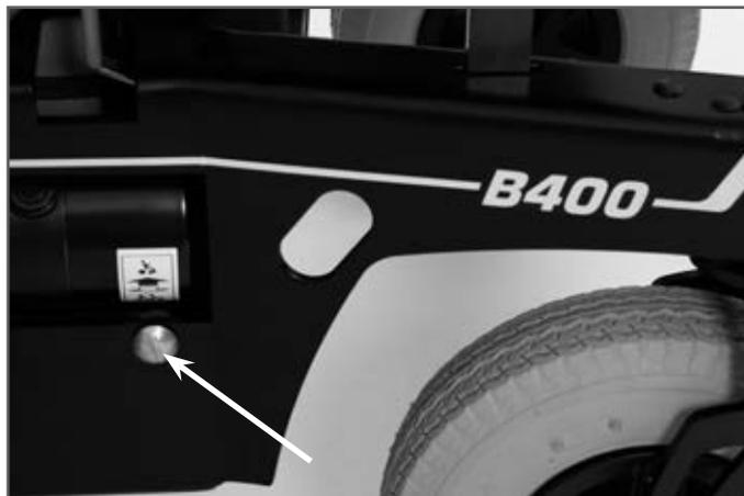
Fig. 48 Centro de rotação do balancim
