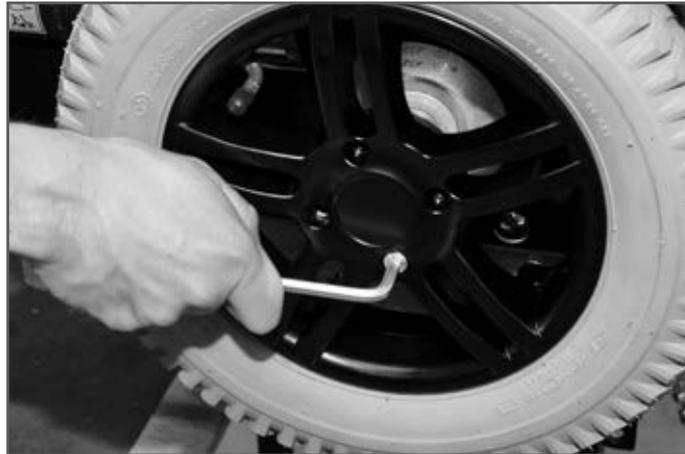
Fig. 20 Desmontar a roda de acionamento
